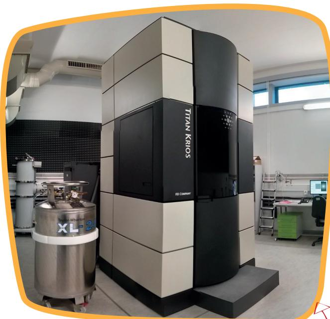
Elektrónový mikroskop Titan Krios umožňuje zobrazovanie biologických makromolekúl zapustených v amorfnom lade.
